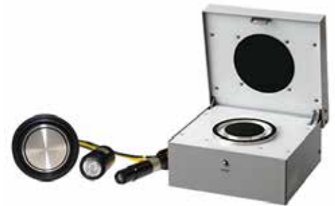
Messbox für Messungen angelehnt an JIS K 6911 bzw. ASTM D257
